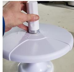
Schrauben Sie das 4G-Modul oben auf die Antenne.
