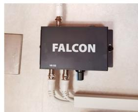
Stellen Sie die TV 1-Kanalliste für terrestrisches Fernsehen ein und stellen Sie TV 2 erneut auf terrestrisches Fernsehen ein. Wenn Sie eine Bildunterbrechung sehen, erhöhen Sie die Stärke des Boosters, indem Sie den Kraftregler in Richtung + drehen.
