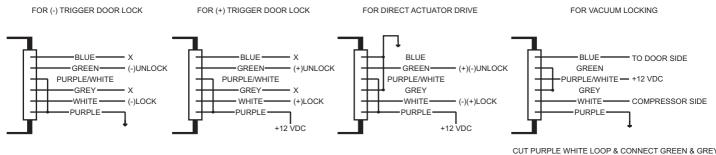
CUT PURPLE WHITE LOOP & CONNECT GREEN & GREY CUT CABLE FROM COMPRESSOR TO DOORS & CONNECT TO BLUE & WHITE AS ABOVE... REMOVE CDL JUMPER TO SET FOR VACCUM LOCKING (SEE OVERLEAF)
